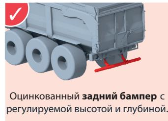
Оцинкованный **задний бампер** с регулируемой высотой и глубиной.
