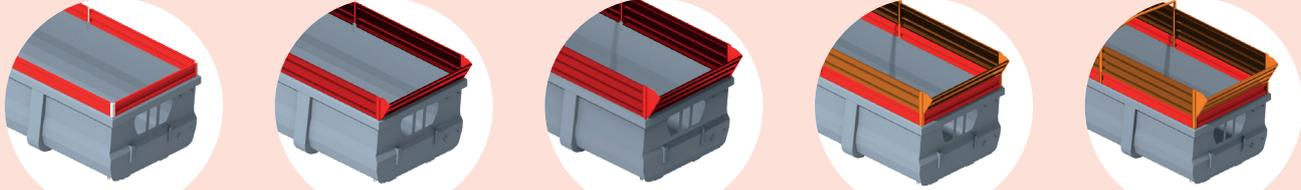
**Надставные борта 300 мм** (сталь или алюминий), **500 мм** (алюминий) или **700 мм** (алюминий), до максимальной высоты 1 м.
